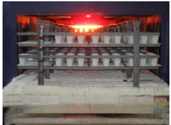
Abb. 20 Durchlaufofen in der keramischen Industrie
