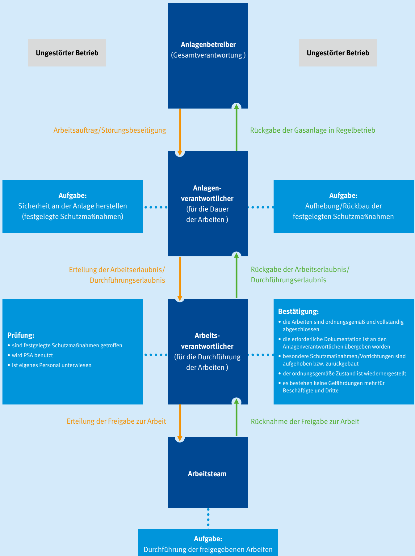
Abb. 7 Beispiel für ein Ablaufschema Arbeitsfreigabeverfahren bzw. Durchführungserlaubnis
