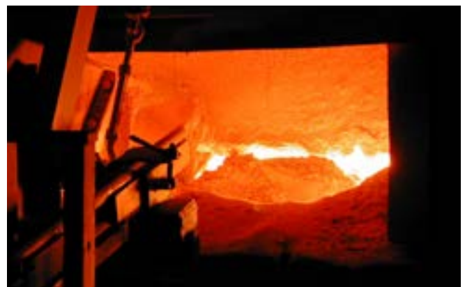
Abb. 21 Blick in eine Schmelzwanne in der Glasindustrie
