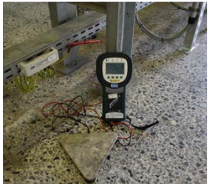
Abb. 34 Dreipunkt-Elektrode und Messgerät
